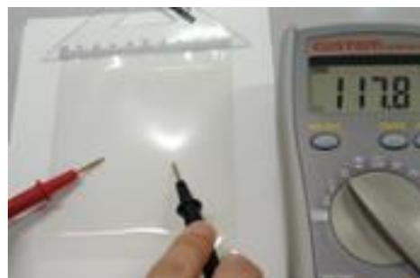
図7 透明導電性ポリマーシートの写真
