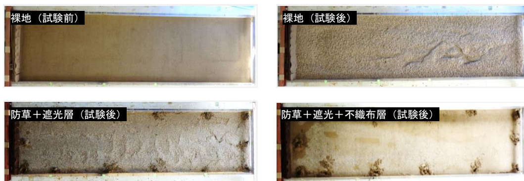
写真 2 各条件の表土状況（人工降雨 150mm/hr 終了、試験品除去後）
