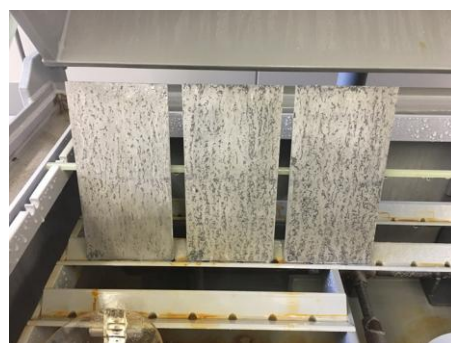
図 1 AZ91D マグネシウム合金板材への塩水噴霧試験 24 時間後の外観
