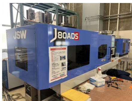
図 5 一体成形に用いた射出成形機
